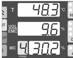
Ukoliko na displejima za temperaturu i ravnotežnu vlagu stoji **Snbr** to označava da su odgovarajuće sonde u prekidu, odnosno da meri nekorektno vrednosti i prijavljuje se alarm.
