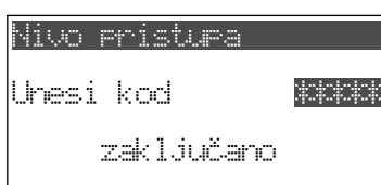
Pozivom ove opcije iz menija na LCD displeju se prikazuje poruka: **Unesi kod**, pored koje стоји 5 zvezdica i status automata (**zaključano / otključano**). Ukoliko se ništa ne pritisne u roku od 4 minuta, sistem se automatski zaključava. Kada se želi ostvariti napredni nivo pristupa potrebno je
