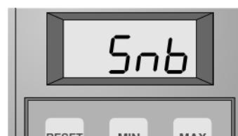
Slika 3.3: Prikaz pri detekciji greške u radu sonde
