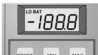
Slika 3.1: Prikaz na displeju za vreme testiranja displeja po uključjenju uređaja
