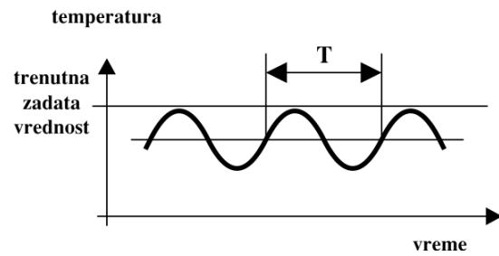
Slika 7.9 Određivanje T metodom oscilovanja zatvorene petlje
