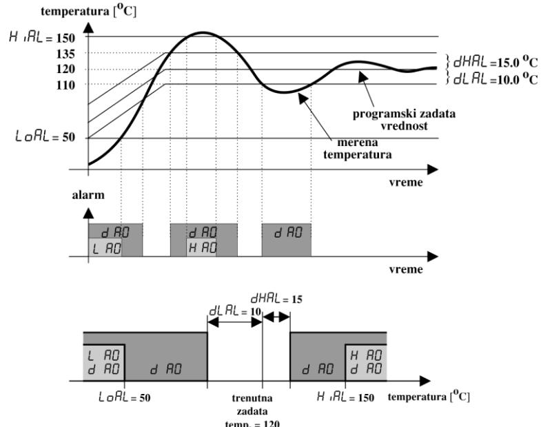
Slika 6.1 Mogućnost aktiviranja više nelečovanih alarma istovremeno
