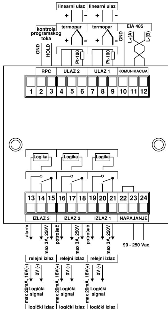
Slika 2.1 Prikaz povezivanja sa zadnje strane uređaja
