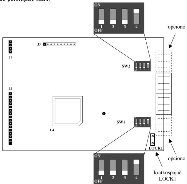
Slika 5.1 Položaj kratkospajača **LOCK1** i DIP SWITCH -eva SW1 i SW2 na gornjoj ploči uređaja
