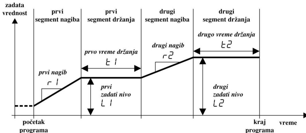
Slika 4.10 Segmentni parametri u okviru jednog programa
